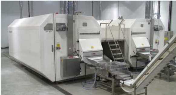
예) Model 10/2 : 시간당 생산성 = 5,900 kg / 장비 길이 = 10,240 mm
