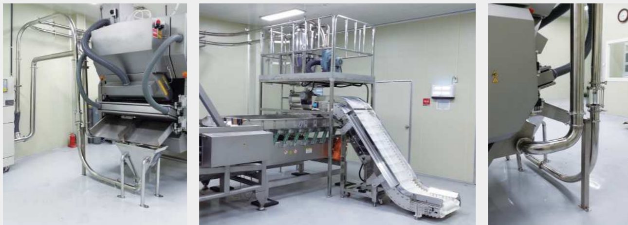
Return System (Pneumatic) 뉴메틱 흡입 이송 : 공간활용, 분진 최소화
