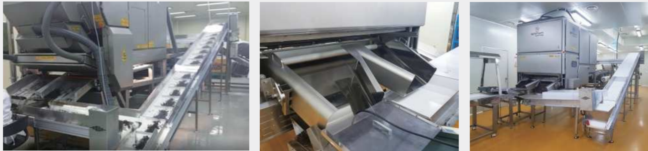
Return System (Conveyor) 양품 또는 결품 자동 재선별
